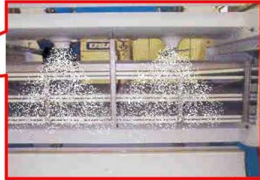
รูปที่ 2-8.13 การลดอุณหภูมิแบบ Cryogenic Freezer
