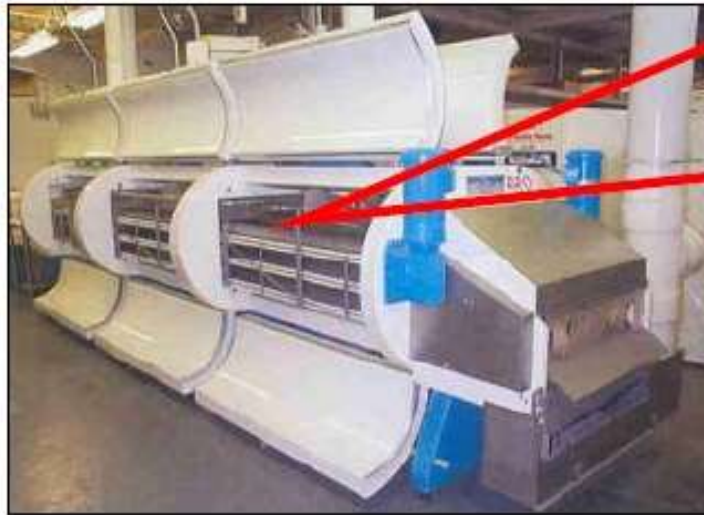
รูปที่ 2-8.13 การลดอุณหภูมิแบบ Cryogenic Freezer
