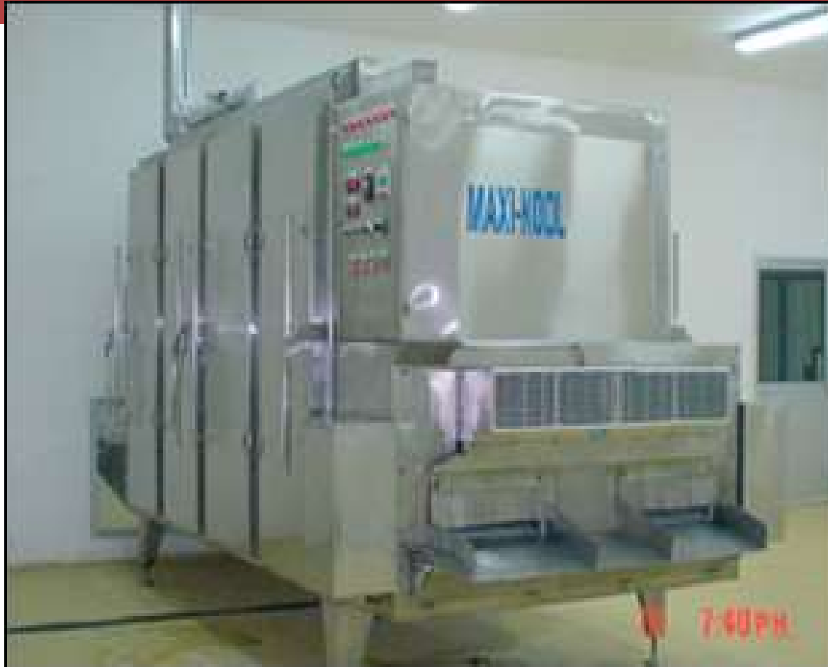
เครื่องแช่แข็งแบบใช้ลมเย็นเป่าชนิดอุโมงค์ (tunnel freezer)
